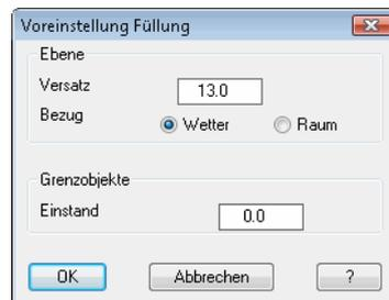
Der Versatz positioniert die Füllung, abhängig vom eingestellten Füllungsbezug, in Wetter- oder Raumrichtung. Dabei gibt ein positiver Wert die Verschiebung in Wetterrichtung und ein negativer die Verschiebung in Raumrichtung an.
