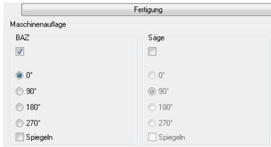
Definiert, wie das Bauteil der Bearbeitungsmaschine aufgelegt wird. Sie können zwei separate Maschinenauflage festlegen. Eine für Bearbeitungszentren (BAZ) und eine für die Säge.
